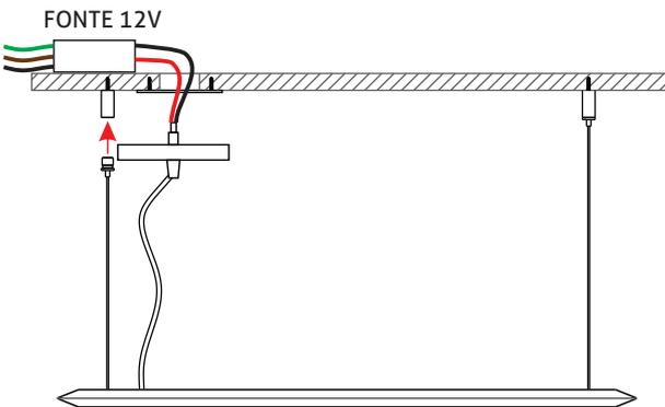
6 - Rosqueie a canopla na travessa e nivele o pendente empurrando ou soltando os cabos de aço. Para soltar o cabo do pitão pressione a trava do pitão conforme desenho abaixo.
