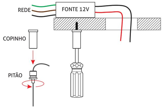
5 - Passe o cabo de alimentação pela canopla e faça a ligação com os cabos da saída 12V da fonte. O cabo **vermelho é o positivo (+)**, e o preto é o negativo (-).
