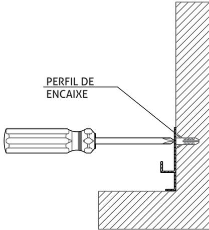
**2** - Retire o perfil frontal de acabamento e encaixe conforme desenho abaixo.
