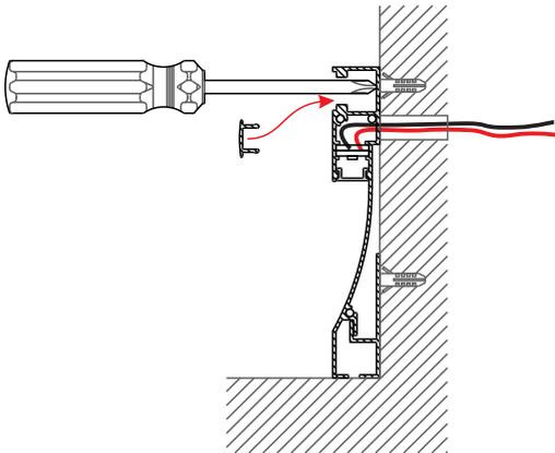
**5** - Verifique se a potência da fonte é compatível com o comprimento da luminária, consulte a tabela de dimensionamento de fontes abaixo. Posicione a fonte em um local ventilado, e com a energia desligada faça a ligação elétrica.
