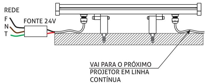
**Instalação com fonte externa (projektor RGB):**
