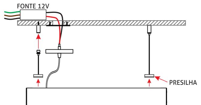
7 - Rosqueie a canopla na travessa e nivele o pendente empurrando ou soltando os cabos de aço, para soltar o cabo do pitão pressione a trava conforme desenho abaixo.
