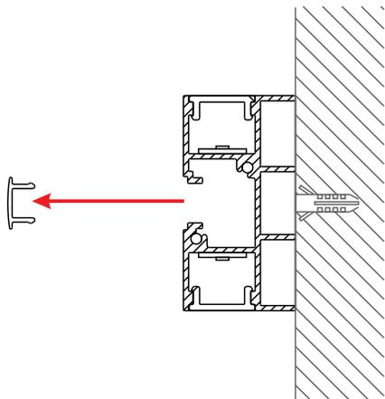
**2** - Passe os cabos de alimentação em direção à fonte de alimentação, e parafuse a arandela.
