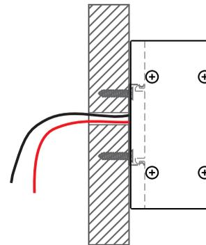
**4** - Posicione a fonte em um local seguro, longe de objetos inflamáveis e com a energia desligada faça a ligação elétrica.
