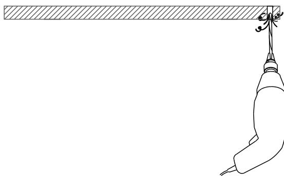
3- Suspenda um segmento por vez e marque a posição dos furos de fixação e da entrada de alimentação no teto.
