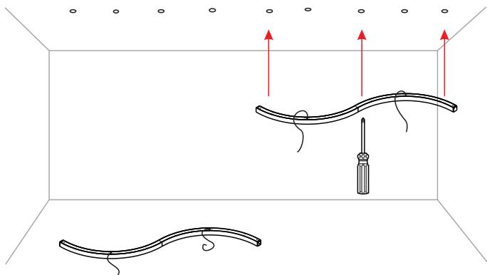
8- Para evitar vazamento de luz, dê o acabamento em todas emendas dos segmentos, utilizando cola PU.
