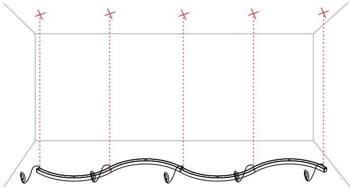
**4- Suspenda um segmento da luminária por vez. Encaixe os cabos de aço nos pitões.**
