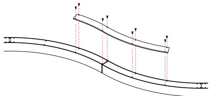
**8- Para evitar vazamento de luz, dê o acabamento em todas emendas dos segmentos, utilizando cola PU fornecida.**
