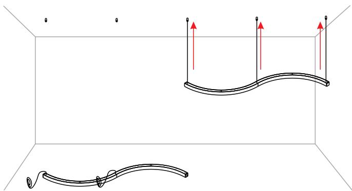
**7- Posicione a(s) fonte(s) de alimentação em local ventilado ou sobre o forro e com a energia desligada, faça ligação elétrica da rede na entrada da fonte, e da luminária na saída 12V. O cabo da luminária está identificado com etiqueta (Positivo +), a malha é o negativo. Isole todas emendas.**
