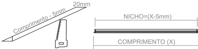
**2** - Parafuse as presilhas de fixação a cada 50cm com parafusos 2,9x13mm.
