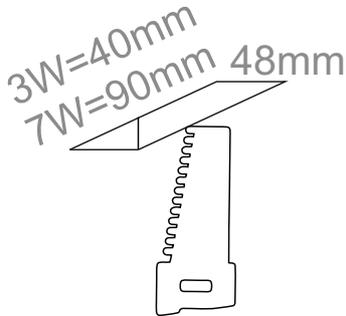
**2** - Com a energia desligada, faça a ligação elétrica do driver, e posicione-o sobre o forro.
