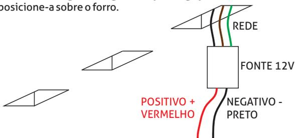
**4** - Passe os cabos 12V positivo e negativo e conecte-os nas luminárias.
