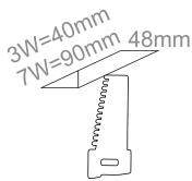
Com a energia desligada, faça a ligação elétrica do driver, e posicione-o sobre o forro.
