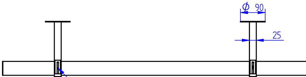
PARAFUSOS P/ AJUSTE DE INCLINAÇÃO
