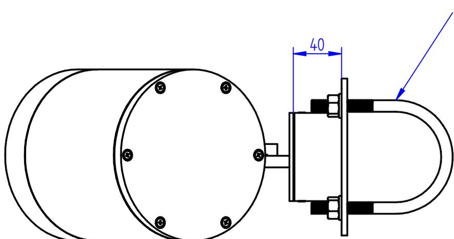
ABRAÇADEIRA TIPO U PARA POSTE  $\phi 60\text{mm}$  A  $\phi 76\text{mm}$
